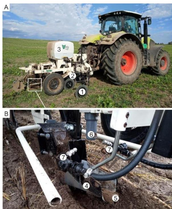
Abbildung 1: Mobile Sensorplattform (MSP 3) von Veris technologies (Salina, USA) mit Geoelektrik (1), optischem Sensor (3) und pH-Messsystem (Wassertank (3), pH-Probenehmer (4), Bodenprobe (5), pH-Elektroden (6) und Sprühdüsen (7) zur Reinigung.
